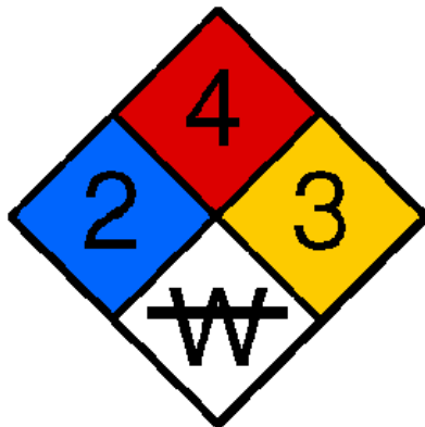
รูปที่ 2 ป้ายกำกับสารเคมีตามมาตรฐาน NFPA
